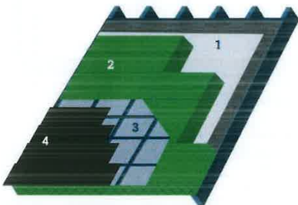
1. Dampscherm | 2. Isolatie | 3. Onderdak | 4. Dakbekleding
